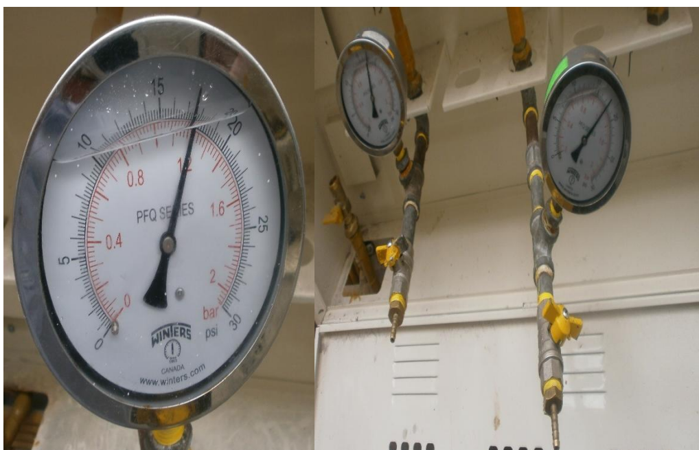
Figura 23. Prueba de hermeticidad – Presión Final: 1.2 bar.
