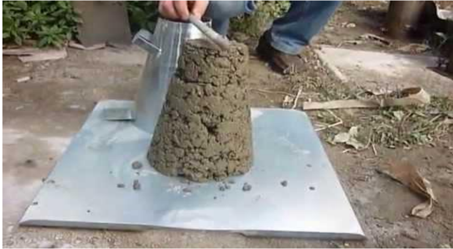
Figura 5: Asentamiento del concreto
