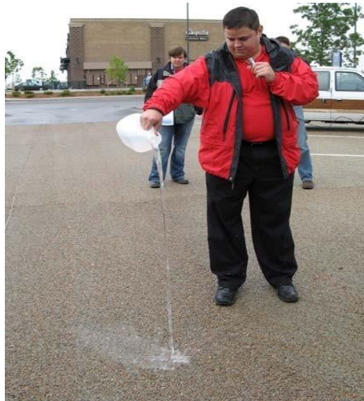
Figura 11: Capacidad de filtración del concreto permeable en un estacionamiento
