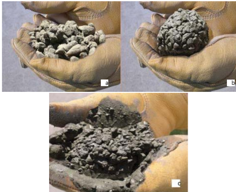
Figura 3: Muestras de concreto permeable con diferentes cantidades de agua. Fuente: Tennis et al. (2004)
