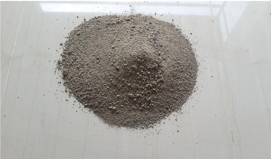
Agregado fino para poder realizar en concreto permeable
