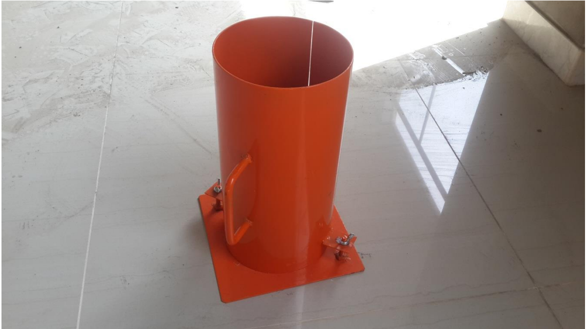
Cilindro para realizar el bloque de concreto y llevar al laboratorio
