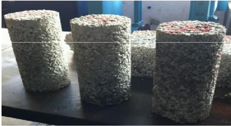
Figura 16. Cilindros de concreto permeable para ensayo a compresión
