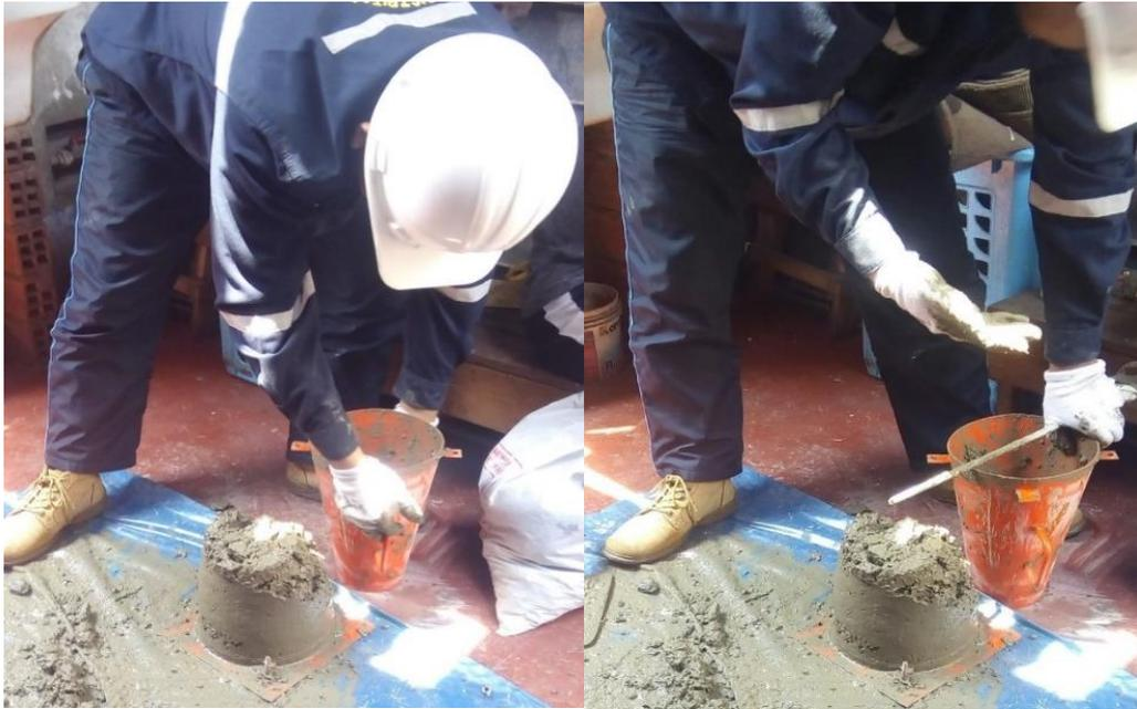
El cono de Abrams se retiro lentamente en forma vertical, no debe hacer ningun movimiento horizontal o giro del cono cuando se esta levantado, la prueba del asentamiento ha sido completado.
