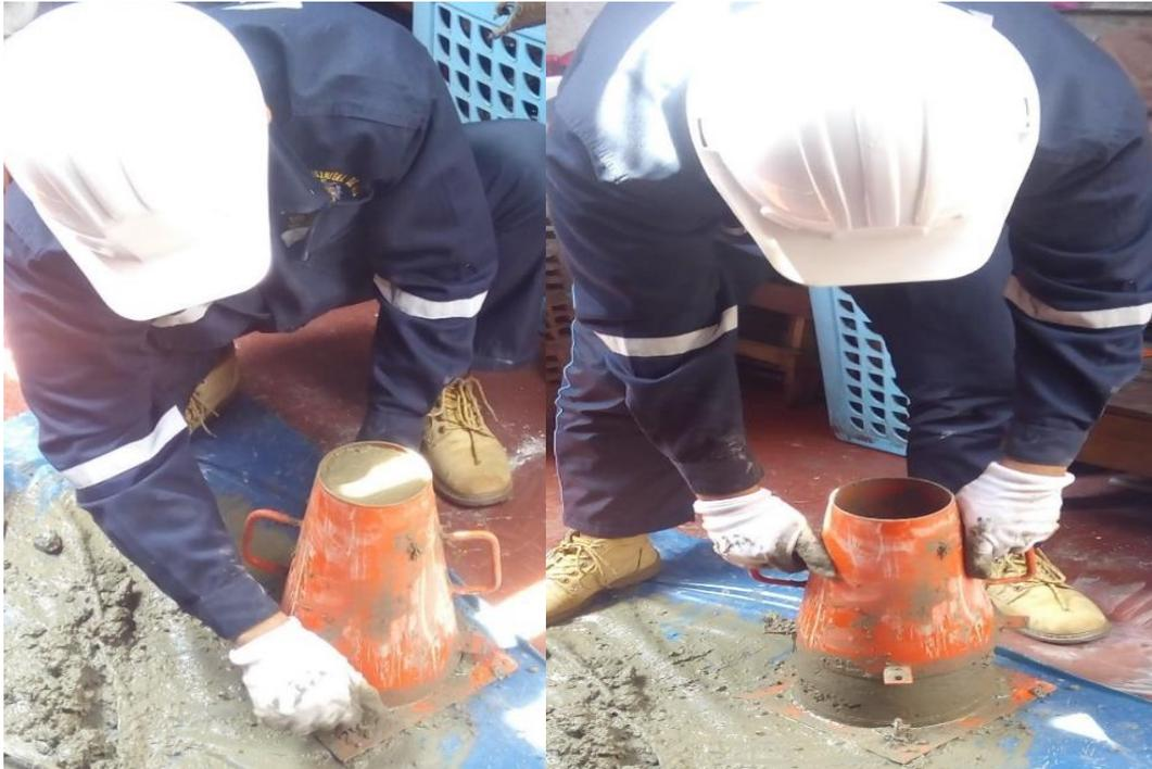
Se observa llenado el cono de Abrams y listo para retiral y medir el asentamiento.
