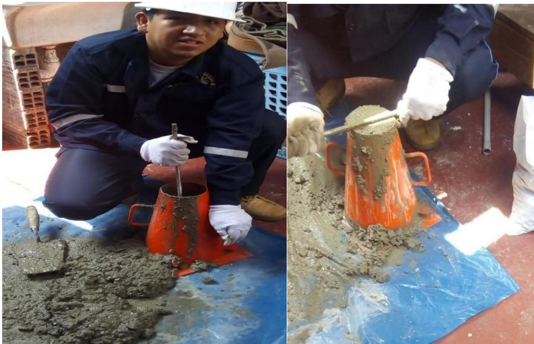
Se compacta la mezcla con 25 golpes verticales, luego de hacer el proceso 3 veces hasta llenar el cono de Abrams se enrasa la parte superior del cono.
