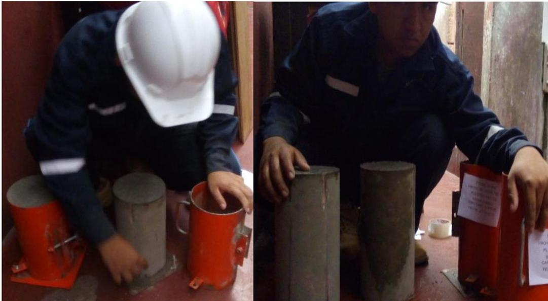
Se observa las probetas 5,6,7,8 listas para ser curadas
