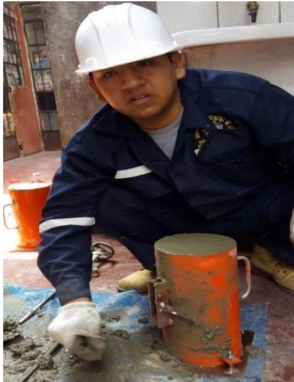
Luego se procede a enrasar con una plancha metálica
