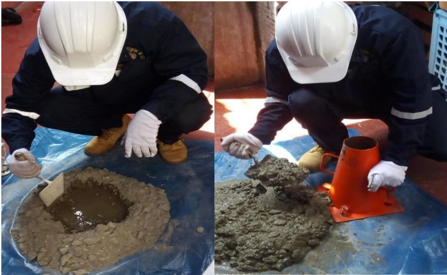
Se muestra el batido de la mezcla y el llenado de la mezcla en 3 capas, se lleno el molde aproximadamente 1/3 de su volumen.
