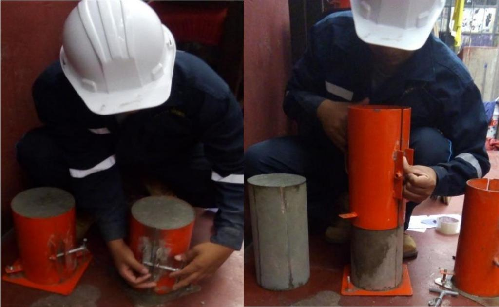
Después de las 24 horas se puede desmoldar y ver nuestras probetas 1,2,3,4, con sus respectivos porcentajes
