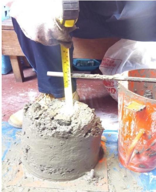
Por fin, se determinó el asentamiento, esta es la resta vertical entre la parte superior del cono y el primer foco desalojado en la parte superior del exterior del concreto.
