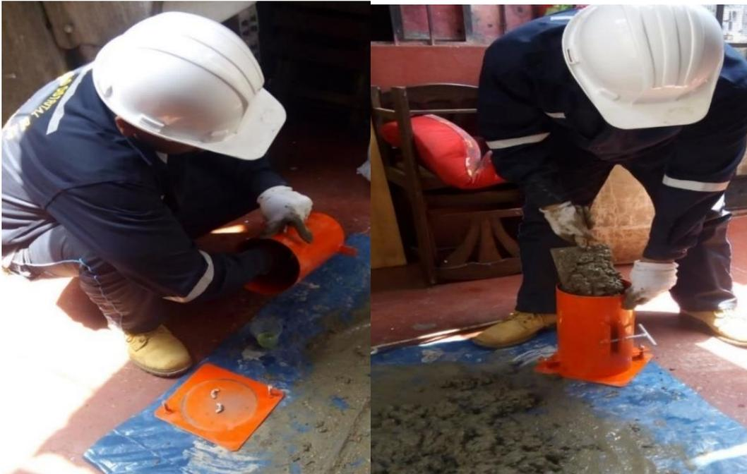
Se observa la lubricación de la parte interior de la probeta, se llena la primera capa con concreto aproximadamente  $\frac{1}{3}$  del volumen del molde.
