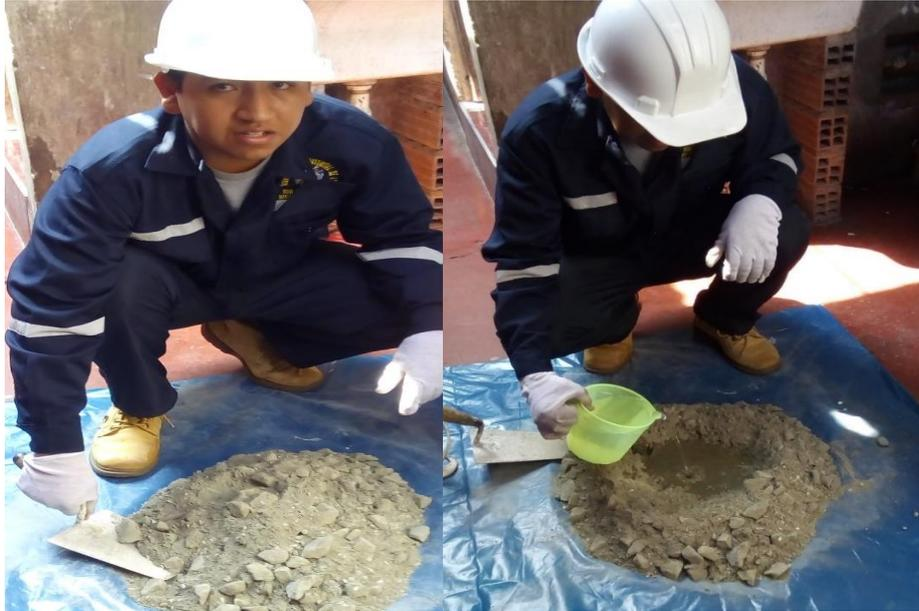
Se muestra la mezcla o batido de los agregados y plástico PET.
