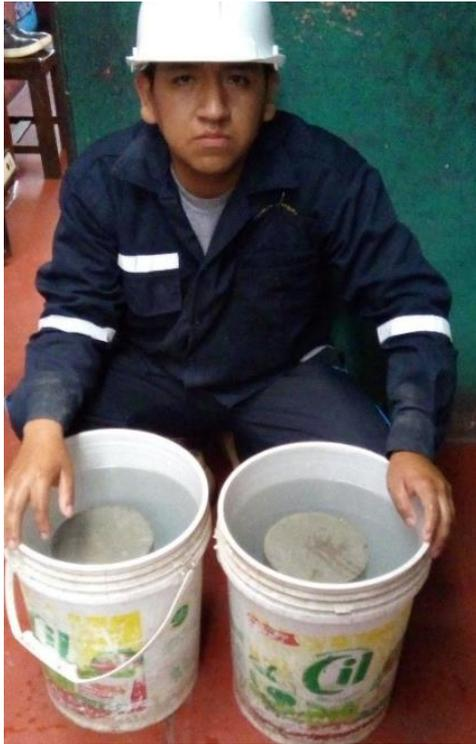
Se observa el proceso de curado por inmersión en agua potable las distintas probetas.
