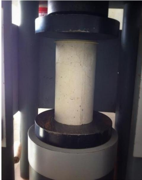
Prueba de resistencia a compresión así sucesivamente cada uno de los especímenes.
