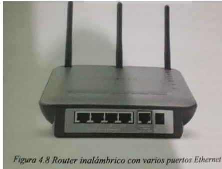
Figura 4.8 Router inalámbrico con varios puertos Ethernet
