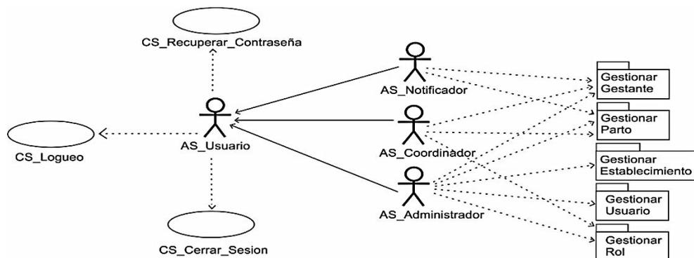
Figura 21: Diagrama de caso de uso del sistema
