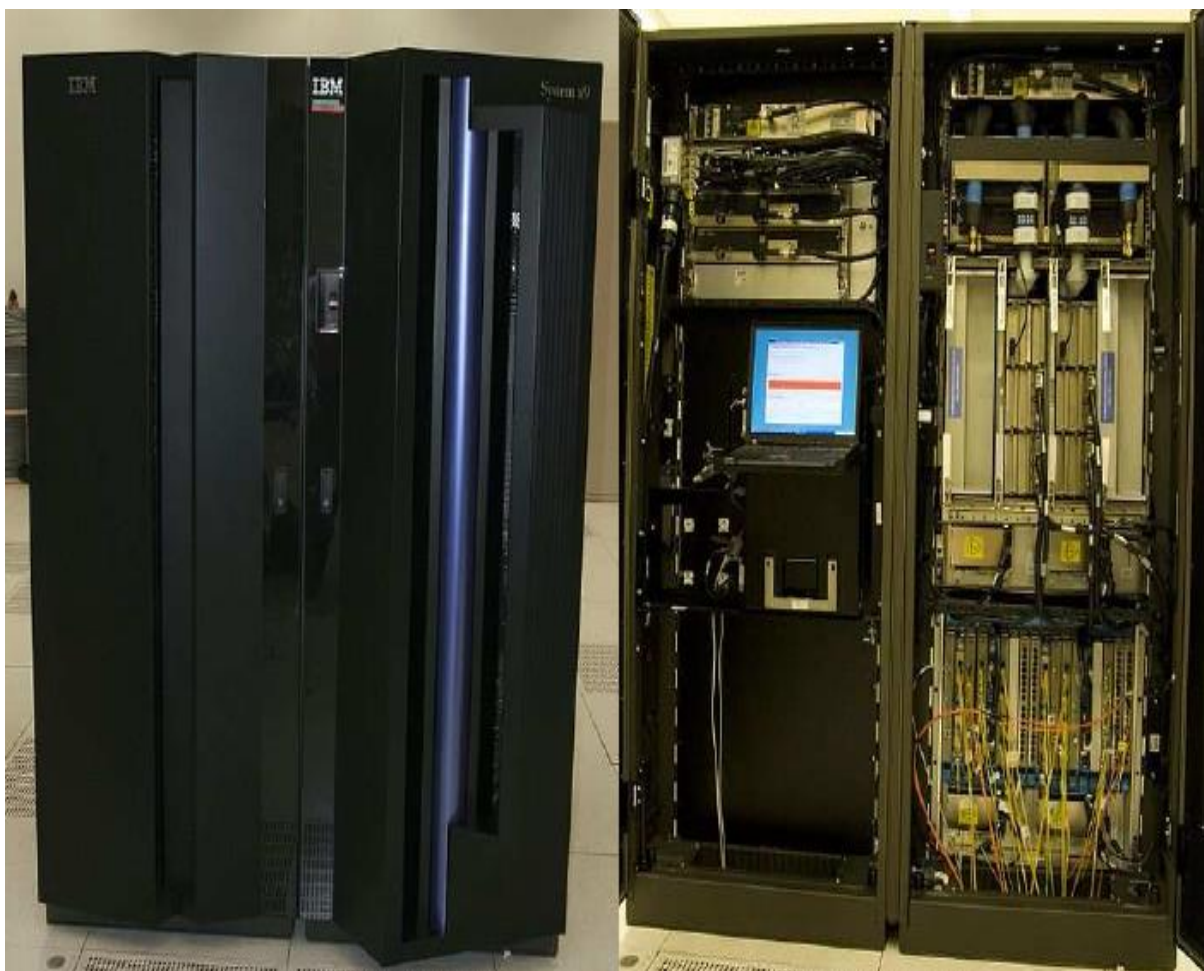
Figura 3: Parte frontal e interior del mainframe IBM 2094 System z9, que corre actualmente desarrollos de máquinas virtuales utilizadas en los primeros mainframes con virtualización de IBM
