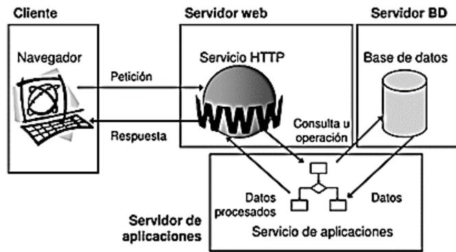
Figura 11. Esquema servidor de aplicaciones todo por separado
