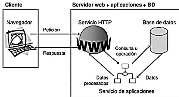
Figura 9. Esquema todo en un servidor con servicios de aplicaciones
