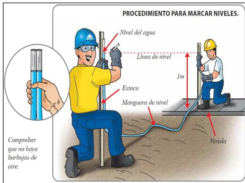
**Figura 5.** Procedimiento de marcar nivelación en terrenos
