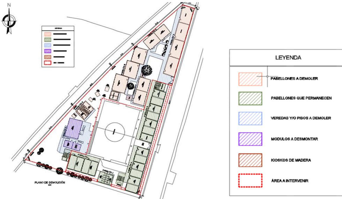
Figura 4. Plano de demolición. Fuente: Consorcio del sur
