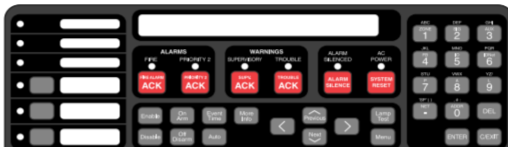
Imagen 1: Interface del Operador del panel de detección y alarma de incendios.
