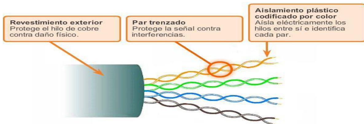
Figura 11. Características del cable stp (revestimiento y aislamiento) Fuente: cisco networking academy
