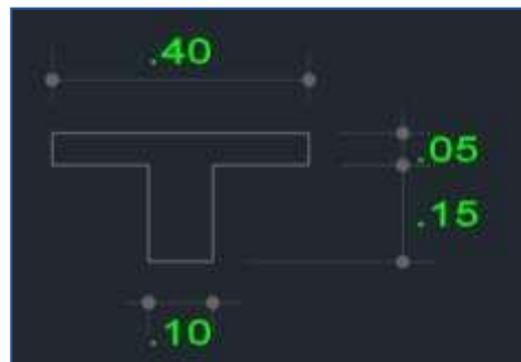
Vigueta ( 0.10 \times 0.20 \times 0.40 ) m
