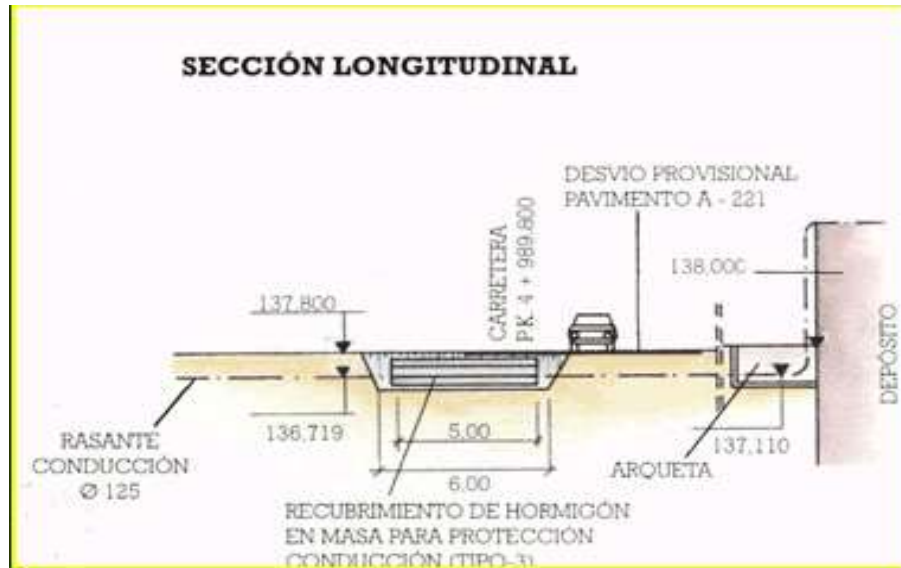
Figura 11. Profundidad de tuberías
