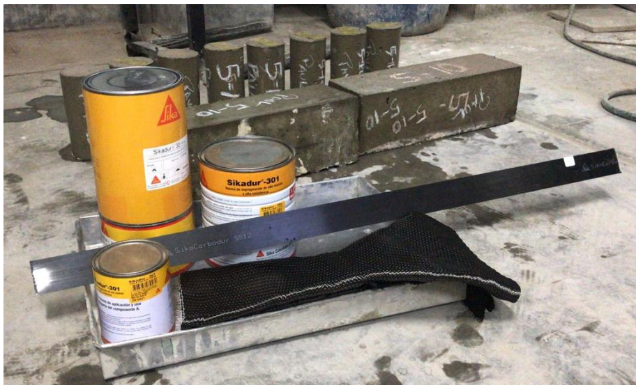
Figura 44: fibra de carbono y epóxico Fuente: elaboración propia
