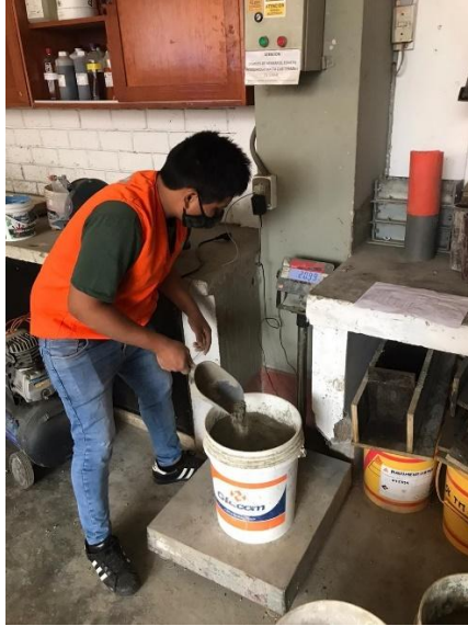
Figura 34: pesado de agregado según diseño de mezcla Fuente: elaboración propia
