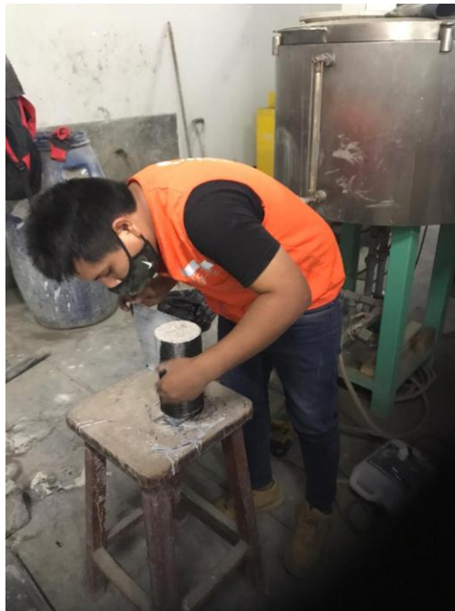
Figura 48: pegado de la fibra de carbono sobre la probeta cilíndrica Fuente: elaboración propia
