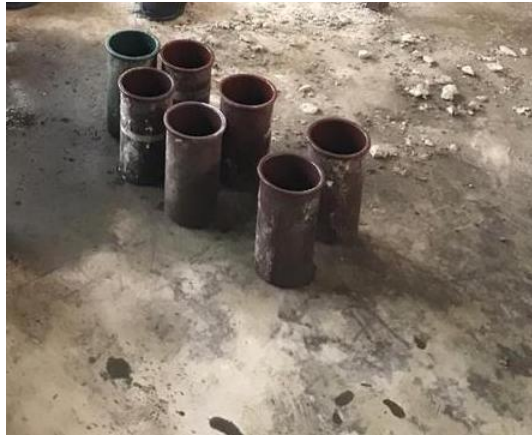
Figura 31: probetas cilíndricas de 10cm de diámetro x 20 cm de largo Fuente: elaboración propia
