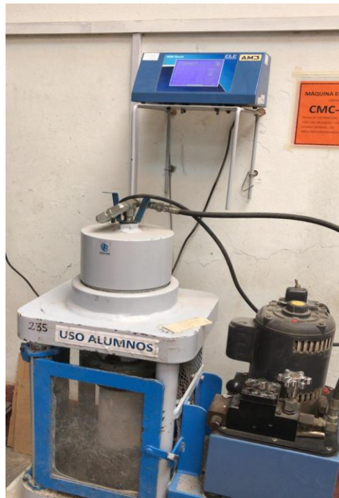
Figura 54: probeta patrón en ensayo a compresión Fuente: elaboración propia
