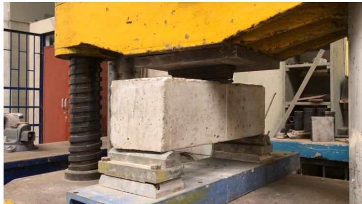
Figura 58: viga lista para su respectivo ensayo a flexión Fuente: elaboración propia
