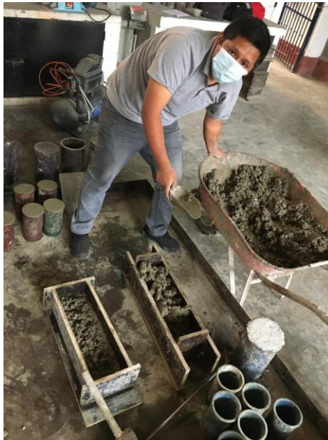
Figura 37: vaciado de concreto en vigas en 2 etapas Fuente: elaboración propia
