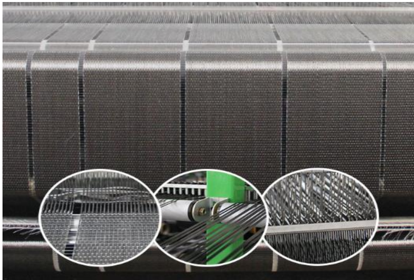
Figura 1: Tejido CFRP – Envoltura de fibra de carbono unidireccional de alta resistencia pre- saturada Proceso de tejido
