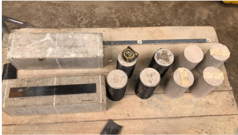
Figura 52: marcado de vigas para su respectivo ensayo a flexión Fuente: elaboración propia
