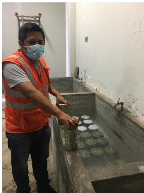
Figura 40: curado de probetas en una poza de agua con cal Fuente: elaboración propia
