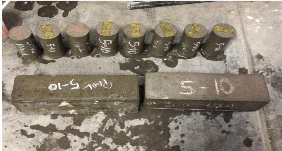
Figura 43: secado de probetas a temperatura ambiente Fuente: elaboración propia
