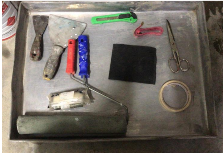
Figura 42: materiales y herramientas para el proceso de colocación de la fibra de carbono Fuente: elaboración propia
