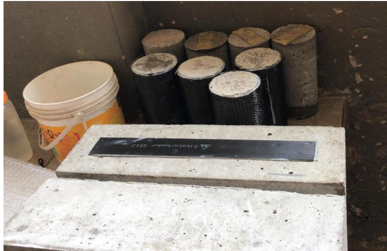
Figura 49: probetas reforzadas con la fibra de carbono
