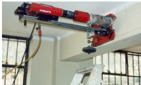
Figura 12: Equipo de perforación para la extracción de núcleos
