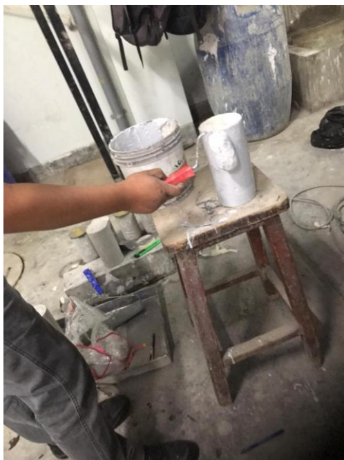
Figura 46: aplicación del epòxico en la probeta cilíndrica Fuente: elaboración propia
