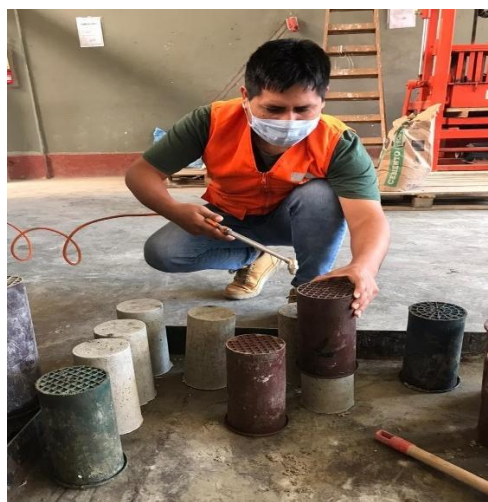
Figura 39: desmoldado de probetas cilíndricas Fuente: elaboración propia
