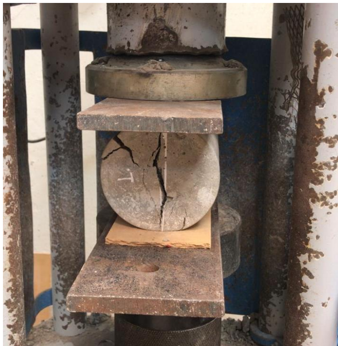
Figura 56: ensayo a tracción por compresión diametral de probeta patrón Fuente: elaboración propia
