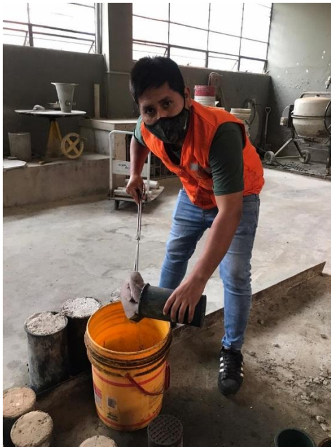
Figura 36: aplicación de aditivo desmoldante a probetas Fuente: elaboración propia
