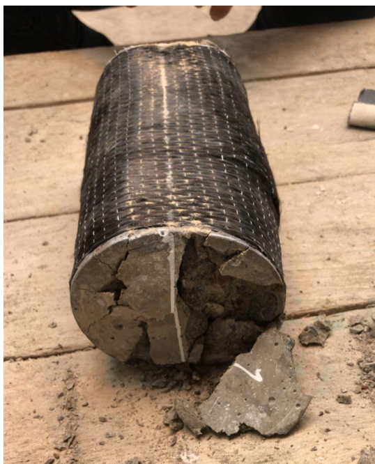
Figura 57: ensayo a tracción por compresión diametral de probeta reforzada Fuente: elaboración propia
