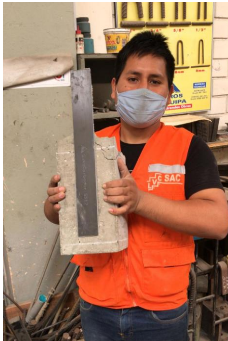
Figura 60: Rotura de viga reforzada con fibra de carbono Fuente: elaboración propia
