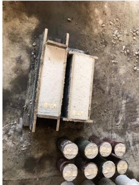
Figura 38: concreto vaciado después de 24 horas Fuente: elaboración propia
