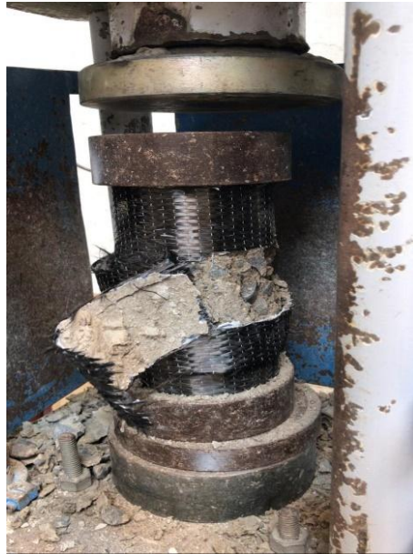
Figura 55: rotura de probeta reforzada con fibra de carbono Fuente: elaboración propia
