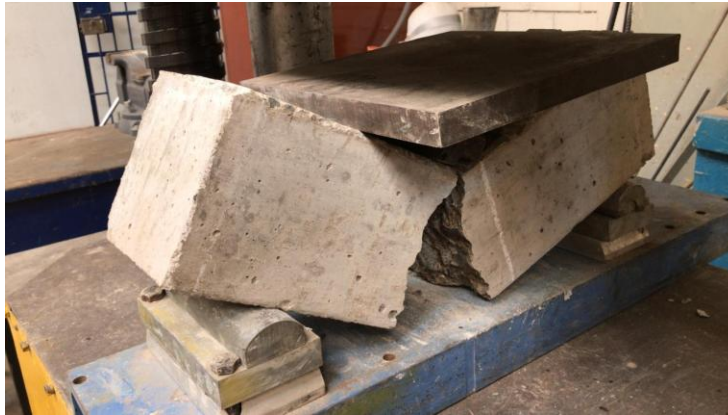
Figura 59: ensayo de viga hasta que se produce la falla Fuente: elaboración propia
