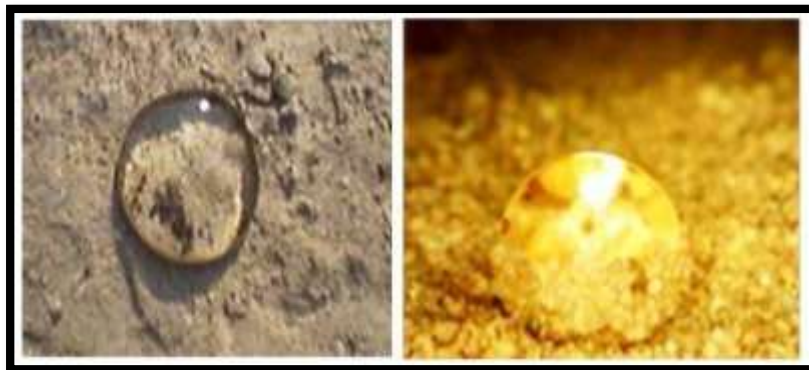
Figura 23. Aspecto de gotas de agua depositadas sobre suelos tratados con Terrasil como se puede observar, la repelencia de la gota es total.
