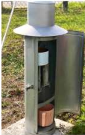
Figura 28. Pluviógrafo, instrumento que grafica la lluvia Fuente : Meteorología, óptica y Precisión. Raig
