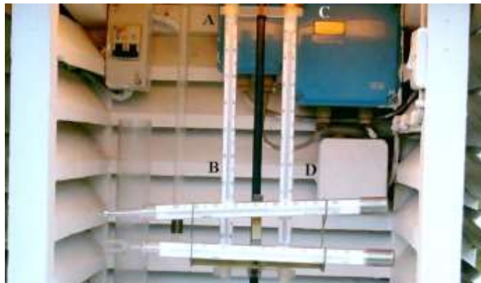
Figura 19. Psicrométrico, instrumento que mide la humedad Fuente : MeteorologíaenRed
