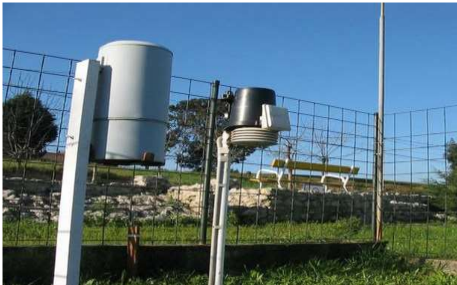
Figura 26. Pluviómetros, instrumento recolector de precipitación Fuente : Meteorología, óptica y Precisión. Raig
