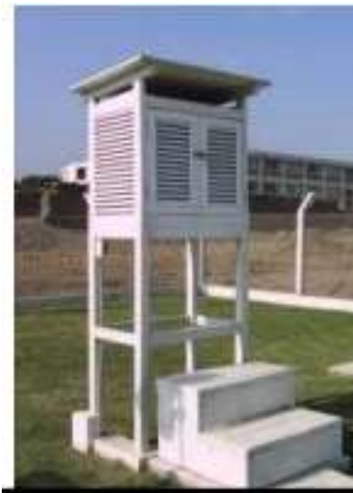
Figura 10. Caseta meteorológica, contiene los termómetros de aire Fuente : Pontificia Universidad Católica del Perú
