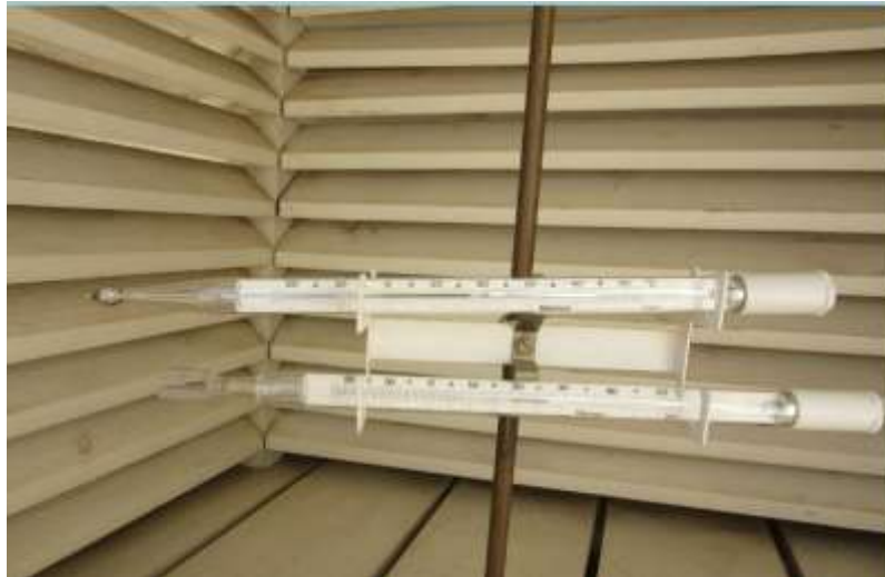
Figura 14. Termómetro de mínima (inferior) con el termómetro de máxima (superior) dentro de la caseta meteorológica Fuente : meteoglosario AEMET
