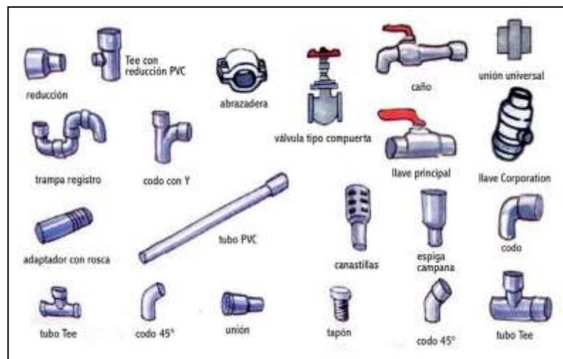
Figura: Tuberías y accesorios
