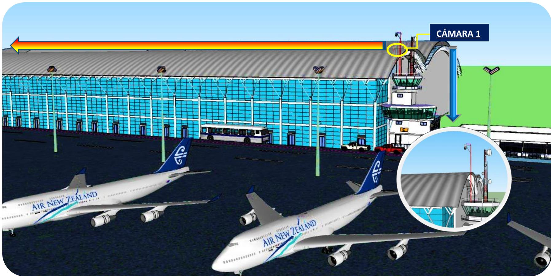
Figura 40. Cámara 1 vista de lejos; se observa que queda a una altura mayor a la del terminal de pasajeros.
