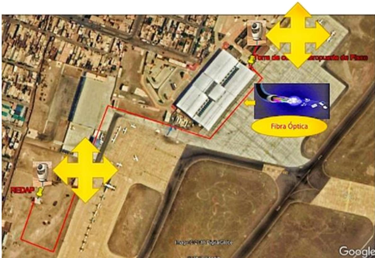
Figura 38. Vista panorámica del recorrido de fibra óptica desde la Torre de Control hasta sala de equipos REDAP señalado con línea roja con distancia de más de 1Km.
