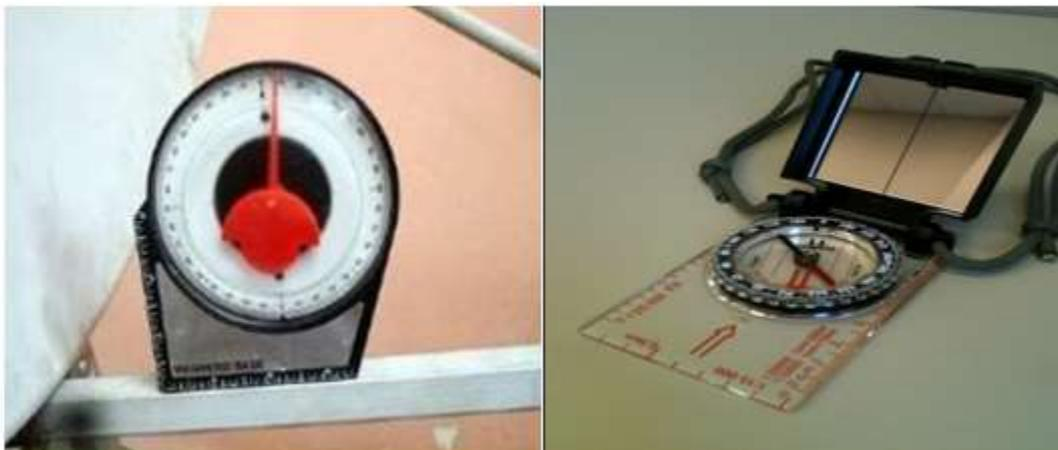
**Figura: Equipos para medir ángulo de inclinación de las antenas (izquierda) y azimuts (derecha)**
