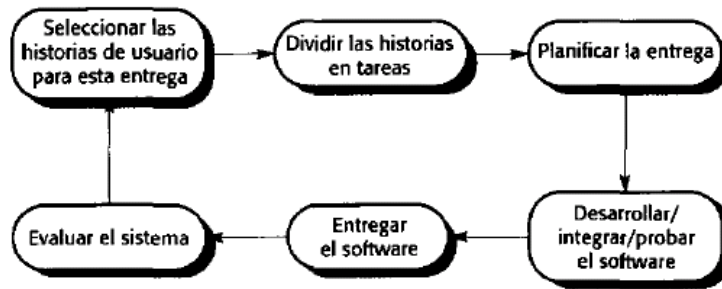
Figura 1. Ciclo de entrega en la programación extrema. Fuente: http://zeus.inf.ucv.cl/~bcrawford/AULA_ICI_3242/Ingenieria%20del%20Software%207ma.%20Ed.%20-%20Ian%20Sommerville.pdf
