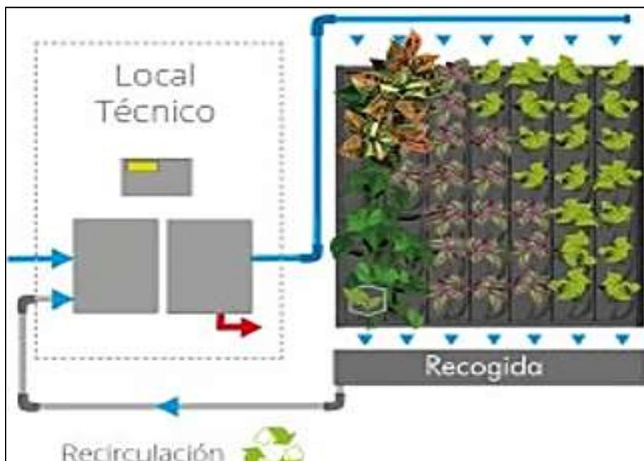
Figura 53. Esquema de riego
