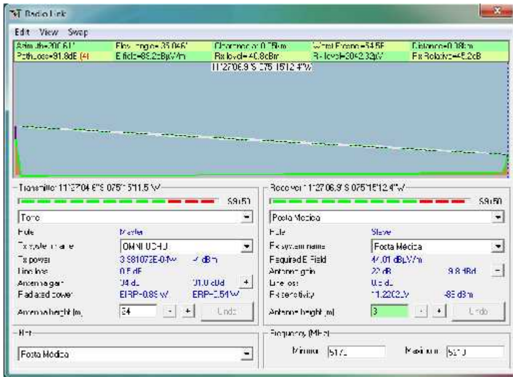
Figura 106: Prueba 5–Nivel de Intensidad de la Señal entre Enlace Torre – Centro Médico.
