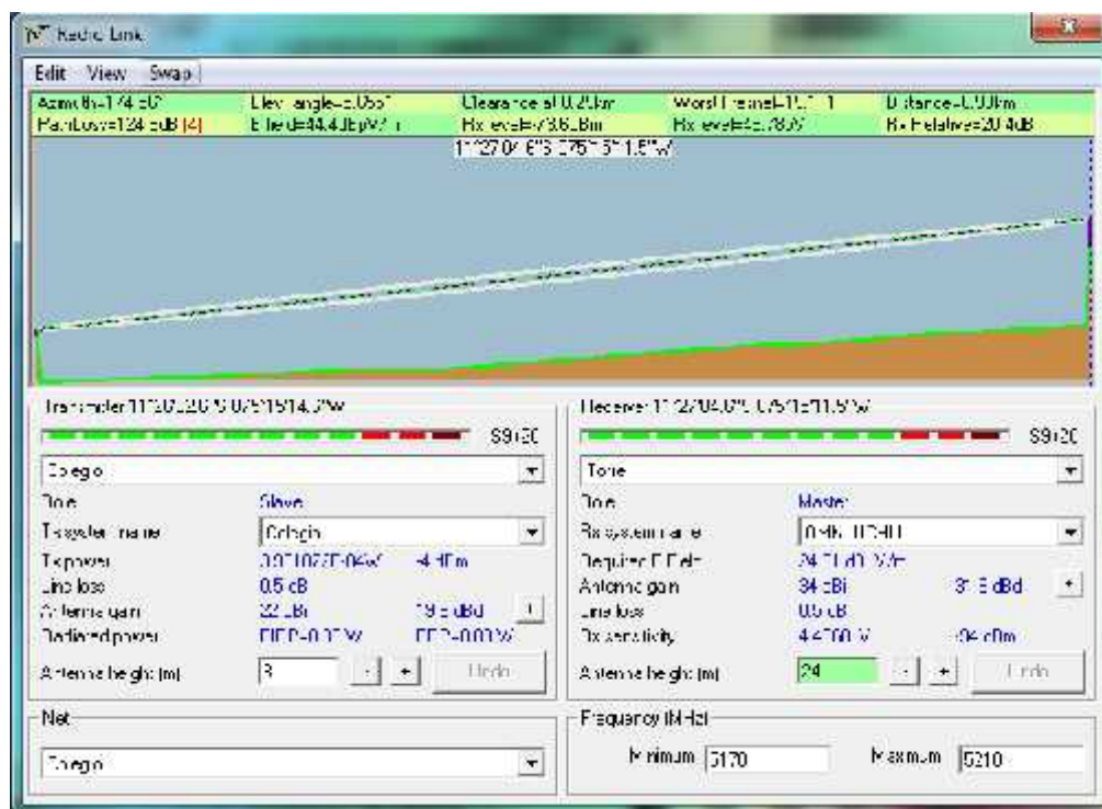
Figura 101: Prueba 4–Nivel de Intensidad de la Señal entre Enlace Colegio - Torre.
